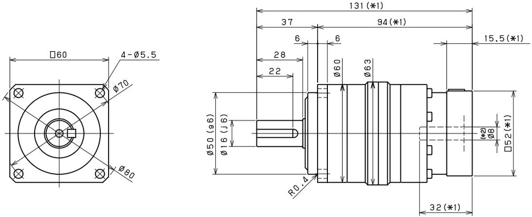
**Antriebsseitige Lochgröße Input bore size  $\leq \varnothing 14$  mm**
