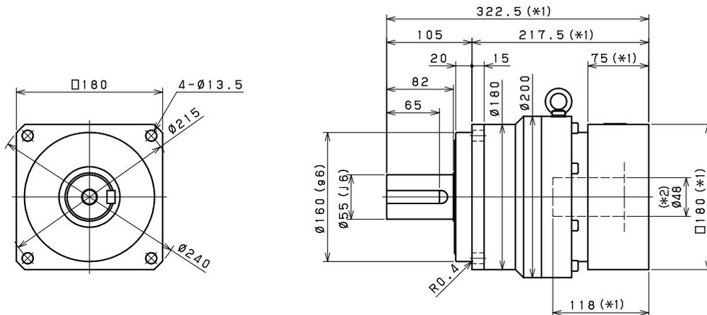
**Antriebsseitige Lochgröße *Input bore size*  $\leq \varnothing 65$  mm**
