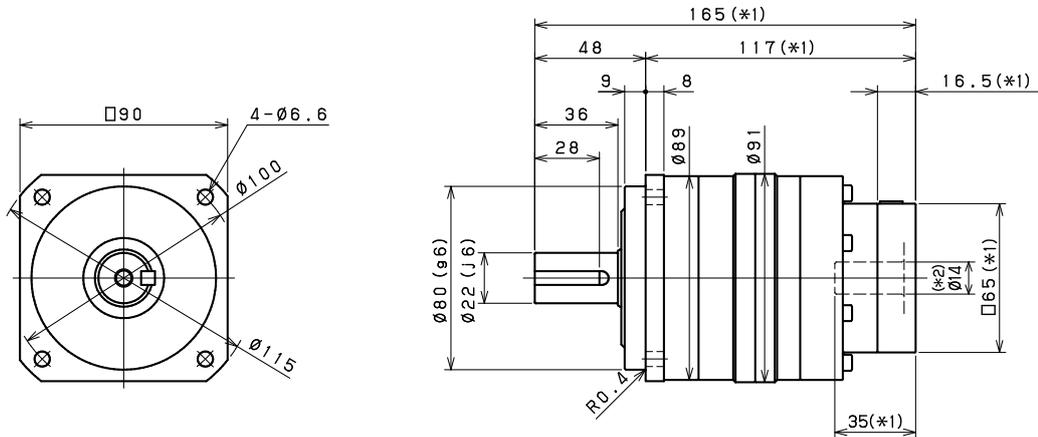
**Antriebsseitige Lochgröße Input bore size  $\leq \varnothing 19$  mm (\*3)**
