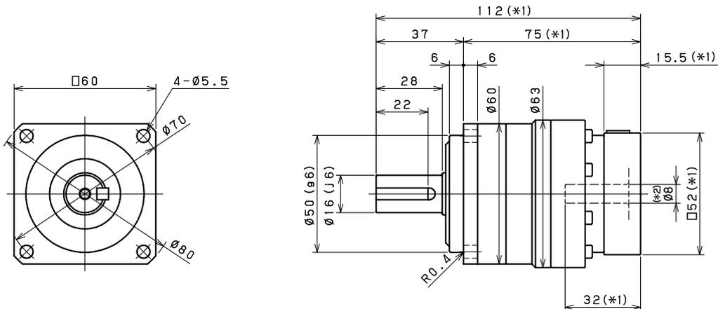
**Antriebsseitige Lochgröße *Input bore size*  $\leq \varnothing 14$  mm**
