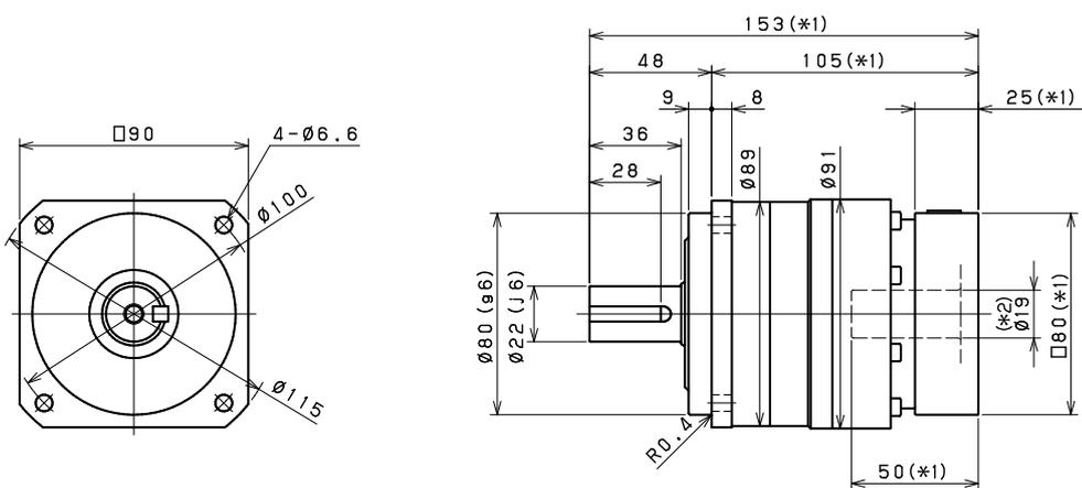
**Antriebsseitige Lochgröße *Input bore size*  $\leq \varnothing 28$  mm**
