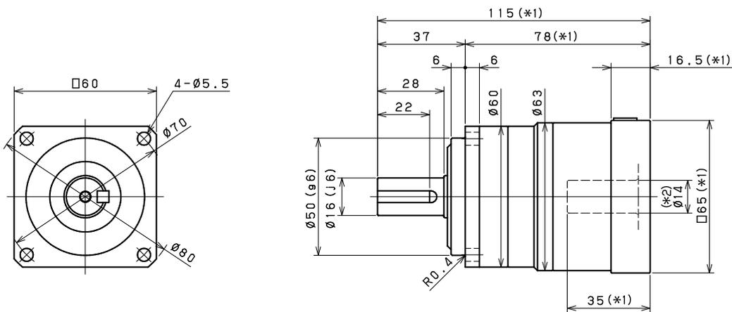
**Antriebsseitige Lochgröße *Input bore size*  $\leq \varnothing 19$  mm**
