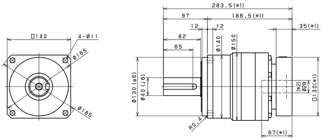
Antriebsseitige Lochgröße Input bore size  $\leq \varnothing 38$  mm (\*3)
