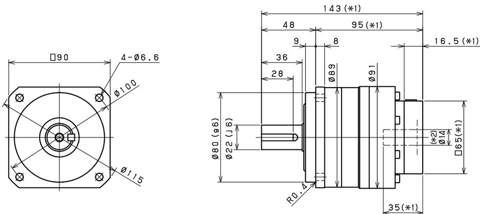
**Antriebsseitige Lochgröße *Input bore size*  $\leq \varnothing 19$  mm**
