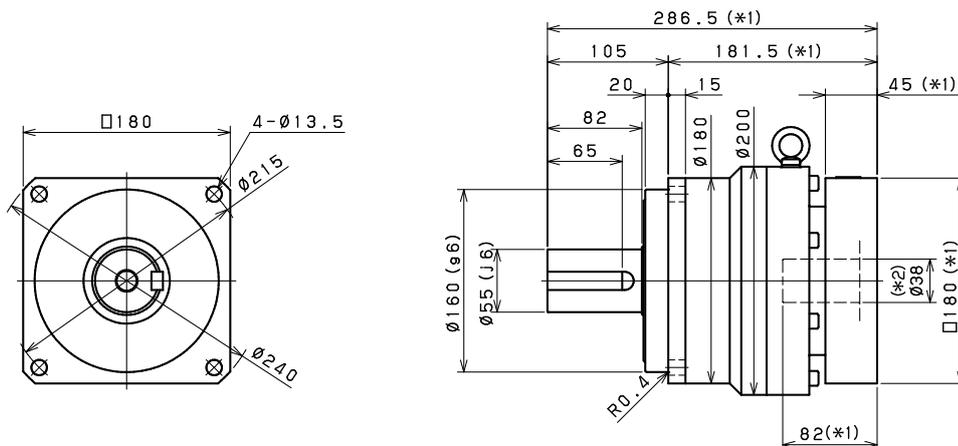
**Antriebsseitige Lochgröße *Input bore size*  $\leq \varnothing 48$  mm**
