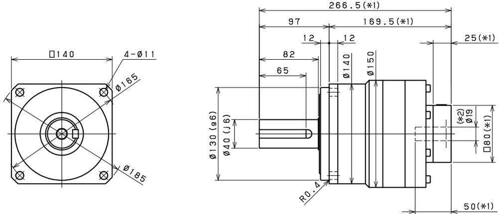
Antriebsseitige Lochgröße Input bore size  $\leq \varnothing 28$  mm
