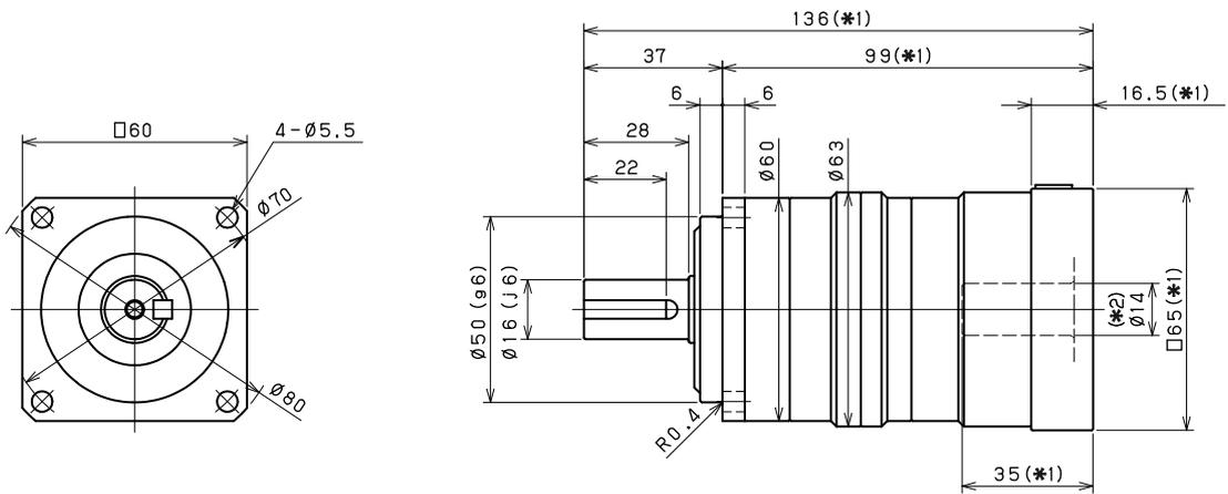
**Antriebsseitige Lochgröße Input bore size  $\leq \varnothing 19$  mm**
